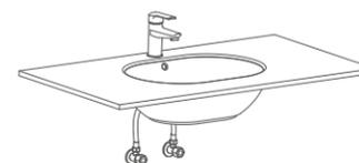
Схема установки кранов для смесителя
