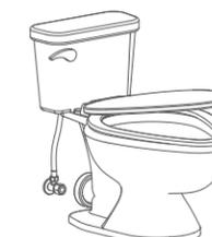
Схема установки крана для унитаза
